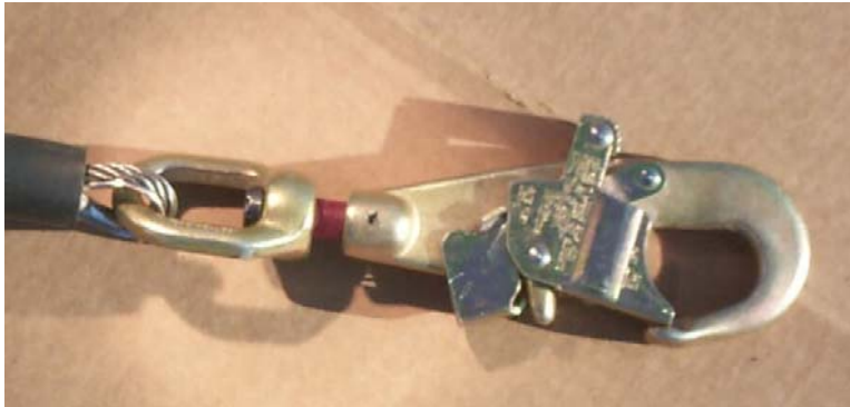
Esta “ SRL ” se ha chocado. Por favor, observe usted el indicador rojo en lo alto de la grapa.
